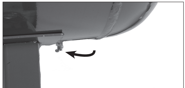
Figure 12 - Drenaje manual del tanque
