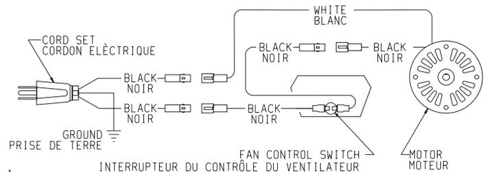
S'il y a un fil original, fourni avec l'appareil, qui doit être remplacé, il doit être remplacé avec un fil du genre 125°C ou l'équivalent.
