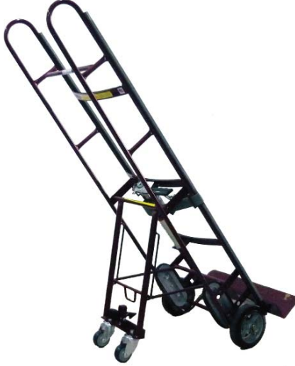
Figura 2 – El Soporte en su Posición Totalmente Fijado
