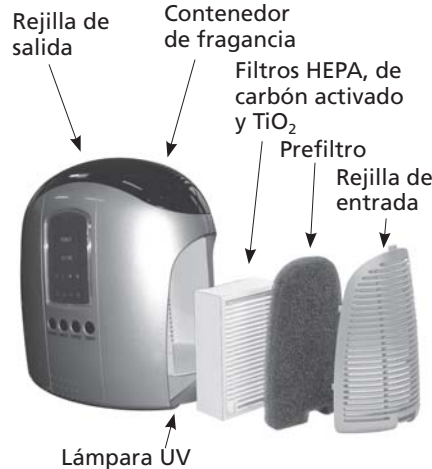
Figura 6 – Partes del Purificador de Aire Modelo 2HPD5A
