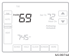
Fig. 7. Relevé de la température intérieure à l'écran d'un thermostat TH8000.
