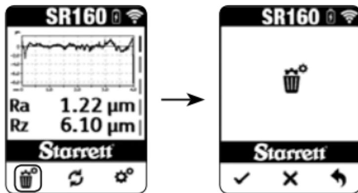
La funzione di ripristino delle impostazioni predefinite funziona solo quando l'SR160 è collegato (tramite Bluetooth o in modalità connesso).
