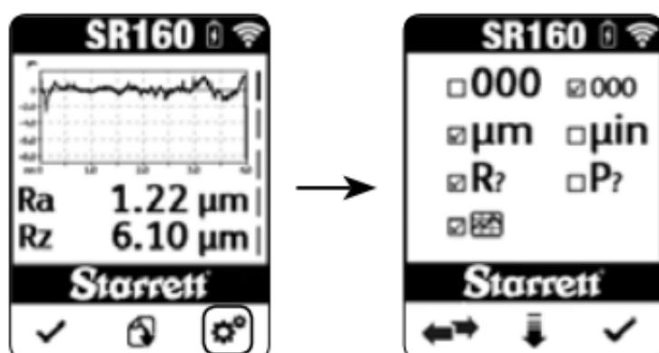
Pressione a seta para baixo para rolar para baixo até a linha de configuração dos parâmetros. Pressione para alternar entre as opções de exibir ou não exibir o gráfico na tela de resultados. Pressione o botão de confirmação para aceitar a configuração e sair do menu de configurações.
