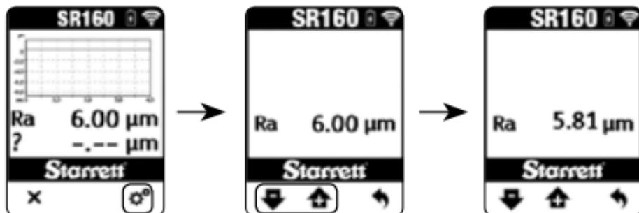
Coloque el SR160 en el patrón de calibración provisto con la unidad (o con cualquier otro patrón certificado). Pulse el botón de medición para tomar una medición del patrón de calibración.
