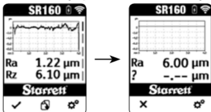
Na tela de calibração, é exibido o valor Ra da última calibração gravada ou o valor padrão. Para mudar esse valor, pressione o ícone configurações. Em seguida, use os botões mais (+) e menos (-) para ajustar o valor Ra de calibração de acordo com o valor desejado. Pressione o botão voltar para aceitar o valor e retornar à tela de calibração.
