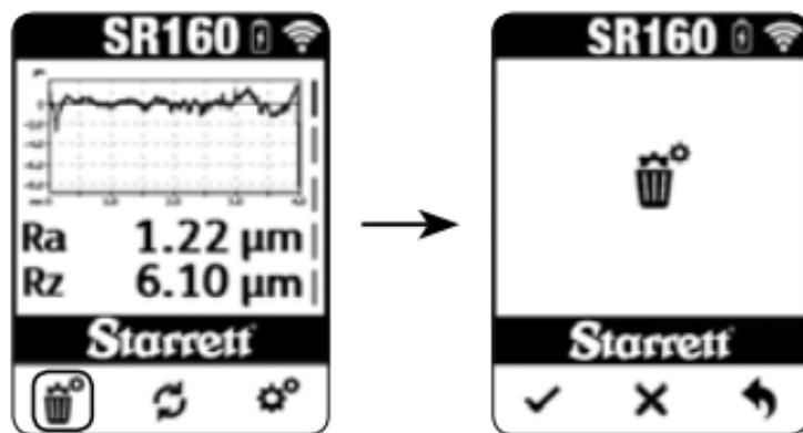
La función de restablecimiento a los ajustes de fábrica sólo funciona cuando el SR160 está apareado (mediante Bluetooth o en el modo conectado).
