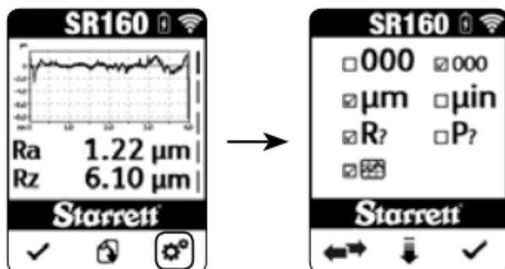
Appuyer sur la flèche descendante pour faire défiler l'affichage vers le bas jusqu'à la ligne de sélection des paramètres. Appuyez sur  $\leftrightarrow$  pour alterner entre les deux options de paramètres ISO 4287 disponibles à l'affichage - rugosité (R) ou primaire (P). Appuyer sur la touche coche pour accepter le réglage et quitter le menu des réglages. L'une ou l'autre option affiche tous les paramètres disponibles pour cette option particulière sur l'écran des résultats.
