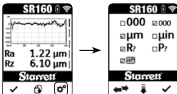
Pulse el botón con la flecha hacia abajo para desplazarse hasta la línea de opción del gráfico. Pulse  $\leftrightarrow$  para alternar entre la opción de visualizar o no el gráfico en la pantalla de resultados. Pulse el botón con la marca de verificación para aceptar el ajuste y salir del menú de ajustes.
