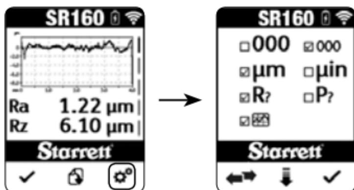
Appuyer sur la flèche descendante pour faire défiler l'affichage vers le bas jusqu'à la ligne de sélection des unités. Appuyer sur  $\leftrightarrow$  pour passer d'une option à l'autre –  $\mu\text{m}$  (métrique) ou  $\mu\text{in}$  ( $\mu\text{po}$ , anglais). Appuyer sur la touche coche pour accepter le réglage et quitter le menu des réglages.
