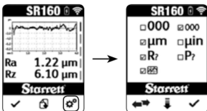
Pulse el botón con la flecha hacia abajo para desplazarse hasta la línea de selección de unidades. Pulse  $\leftrightarrow$  para alternar entre ambas opciones –  $\mu\text{m}$  (métrico) o  $\mu\text{pulg}$  (inglesas). Pulse el botón con la marca de verificación para aceptar el ajuste y salir del menú de ajustes.
