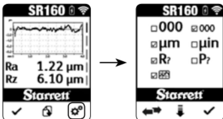
按设置按钮进入设置菜单 在 2 个选项  $\mu\text{m}$  (公制) 或  $\mu\text{in}$  (英制) 之间切换。按确定按钮接受设置并退出设置菜单。
