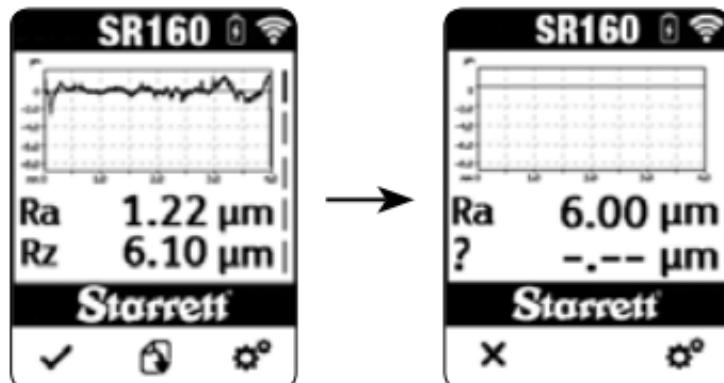
校准屏幕上显示默认或最近保存的校准 Ra 值。按设置图标来更改校准值。使用增大 (+) 和减小 (-) 按钮可将校准 Ra 值调整到期望值。按返回按钮接受数值并返回校准屏幕。
