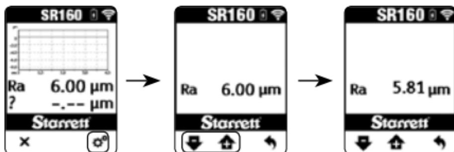
Setzen Sie das Modell SR160 auf den mitgelieferten Kalibrierstandard (oder einen anderen zugelassenen Standard). Drücken Sie die Messtaste, um eine Messung mit dem Kalibrierstandard durchzuführen.
