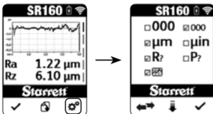
Premere il tasto con la freccia in giù per scorrere alla linea con l'impostazione dei parametri. Premere  $\leftrightarrow$  per alternare tra le 2 opzioni di parametri disponibili secondo le norme ISO 4287 - rugosità (R) o principali (P). Premere il tasto con il segno di spunta per confermare l'impostazione e uscire dal menu delle impostazioni. Entrambe le scelte visualizzano tutti i parametri disponibili per quella particolare opzione sullo schermo dei risultati.
