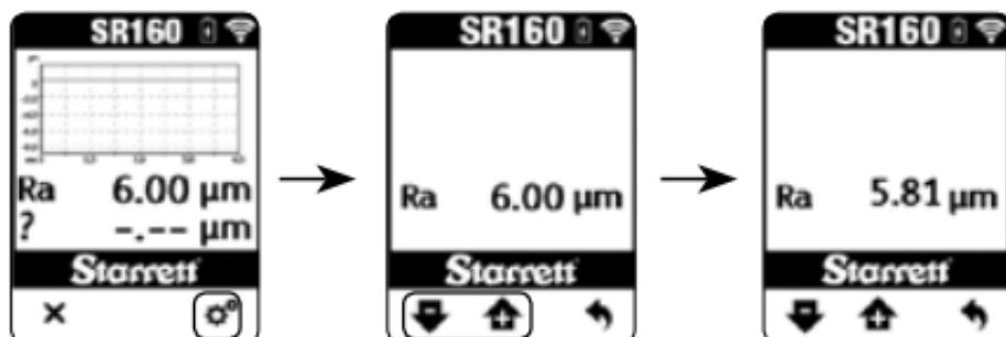
Posizionare l'SR160 sulla piastra di calibrazione standard fornita con l'unità (o un'altra piastra di calibrazione standard certificata). Premere il tasto per effettuare una misurazione sulla piastra di calibrazione standard.
