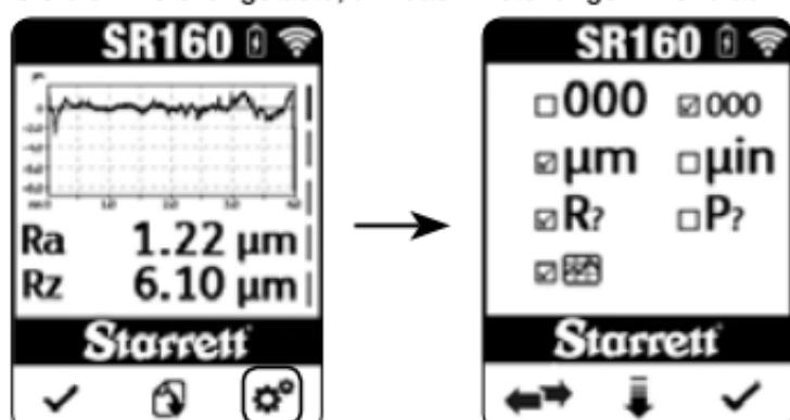
Drücken Sie Abwärtspfeiltaste, um zur Diagramm-Optionszeile hinunter zu blättern. Drücken Sie  $\leftrightarrow$ , um zwischen der Option für die Anzeige des Diagramms bzw. der Option für keine Anzeige des Diagramms auf der Ergebnisanzeige zu wechseln. Drücken Sie die Häkchentaste, um die Einstellung zu übernehmen und das Einstellungen-Menü zu verlassen.
