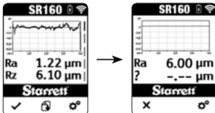
En la pantalla de calibración, aparecerá el valor Ra predeterminado de calibración o el último valor guardado. Para cambiar este valor de calibración, pulse el ícono de ajustes. Luego utilice los botones hacia arriba (+) y hacia abajo (-) para ajustar el valor Ra de calibración al número deseado. Pulse el botón de retroceso para aceptar el valor y regresar a la pantalla de calibración.
