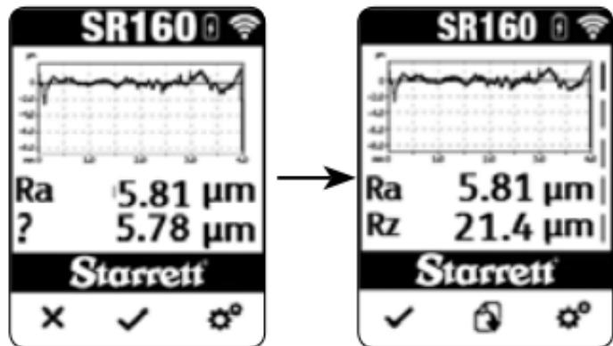
Se la calibrazione è superiore al 10%, viene visualizzato un messaggio di avvertenza.
