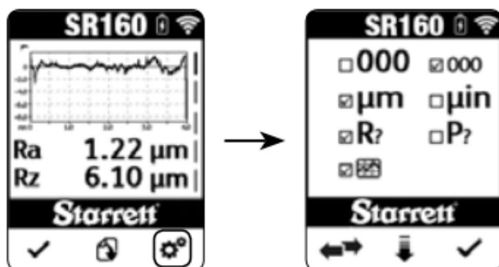
按向下箭头键向下滚动图形选择线框。按下 在结果屏幕上显示或不显示图像的选项之间切换。按确定按钮接受设置并退出设置菜单。
