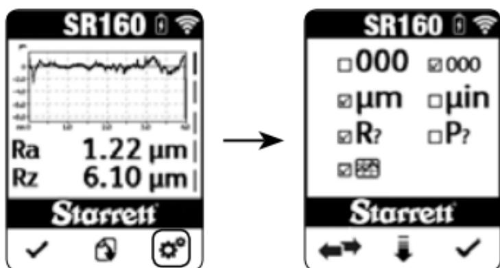
Pressione a seta para baixo para rolar para baixo até a linha de configuração dos parâmetros. Pressione para alternar entre as duas opções de parâmetros ISO 4287 que podem ser exibidas: parâmetros de rugosidade (R) ou principais (P). Pressione o botão de confirmação para aceitar a configuração e sair do menu de configurações. Ambas as seleções exibirão todos os parâmetros disponíveis para a opção em questão na tela de resultados.
