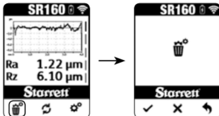
La fonction de réinitialisation ne fonctionne que lorsque le SR160 est jumelé (via Bluetooth ou en mode connecté).
