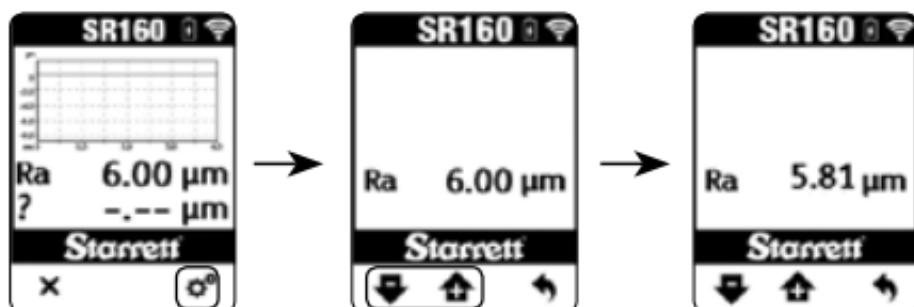
Coloque o SR160 no padrão de certificação fornecido com a unidade (ou qualquer outro padrão de certificação). Pressione o botão de medição para realizar uma medida no padrão de certificação.
