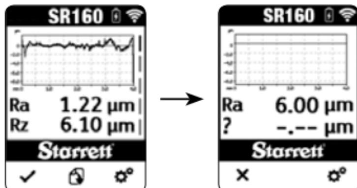
Nello schermo della calibrazione, viene visualizzato il valore Ra dell'ultima calibrazione memorizzata o il valore di default. Per modificare questo valore della calibrazione, premere l'icona delle impostazioni. Quindi utilizzare i tasti su (+) e giù (-) per regolare il valore Ra della calibrazione sul numero desiderato. Premere il tasto indietro per confermare il valore e tornare allo schermo della calibrazione.
