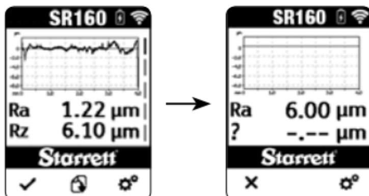
L'écran d'étalonnage affichera soit l'étalonnage par défaut, soit le dernier étalonnage enregistré. Pour modifier cette valeur d'étalonnage, appuyer sur l'icône des réglages. Appuyer ensuite sur les touches haut (+) et bas (-) pour ajuster la valeur d'étalonnage Ra à la valeur désirée. Appuyer sur la touche de retour pour accepter la valeur et revenir à l'écran d'étalonnage.
