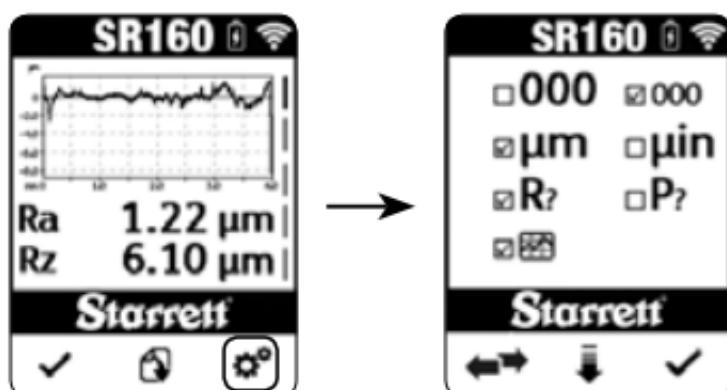
Pulse el botón con la flecha hacia abajo para desplazarse hasta la línea de ajuste de parámetros. Pulse  $\leftrightarrow$  para alternar entre las dos opciones de parámetros ISO 4287 disponibles – Rugosidad (R) o Primarios (P). Pulse el botón con la marca de verificación para aceptar el ajuste y salir del menú de ajustes. Cualquiera de las selecciones mostrará todos los parámetros disponibles para dicha opción en particular en la pantalla de resultados.
