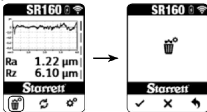
A função de redefinição de fábrica funciona somente quando o SR160 estiver emparelhado (via Bluetooth ou no modo conectado).
