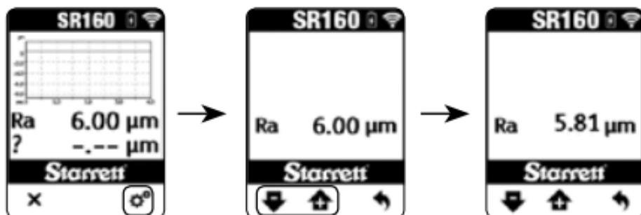
Placer le SR160 sur l'étalon fourni avec l'appareil (ou sur tout autre étalon certifié). Appuyer sur la touche de mesure pour prendre une mesure de l'étalon.
