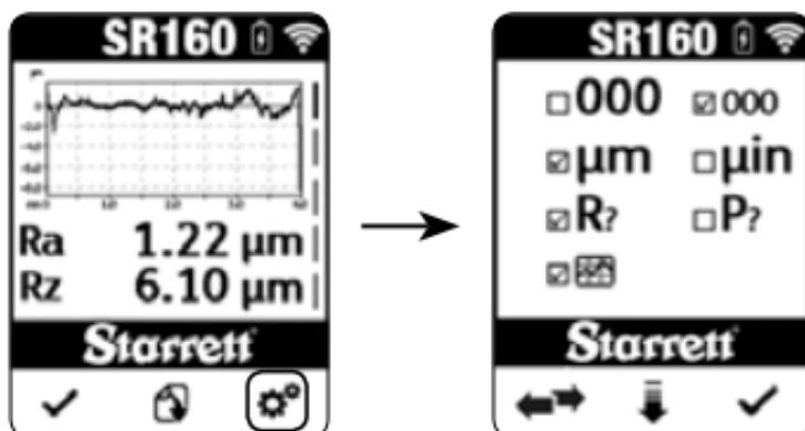
按向下箭头键向下滚动参数设置线框。按下 $\leftrightarrow$ 在 ISO 4287 两个参数选项之间切换: 粗糙度 (R) 和基本参数 (P)。按确定按钮接受设置并退出设置菜单。选择任一选项都会在结果屏幕中出现该选项的所有可用参数。
