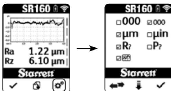
Pressione a seta para baixo para rolar para baixo até a linha de seleção de unidades. Pressione  $\leftrightarrow$  para alternar entre as duas opções:  $\mu\text{m}$  (unidades métricas) ou  $\mu\text{in}$  (unidades inglesas). Pressione o botão de confirmação para aceitar a configuração e sair do menu de configurações.
