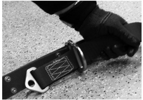
Figura 49 - Tire de la eslinga de cincha a través del anillo en D de doble ranura
