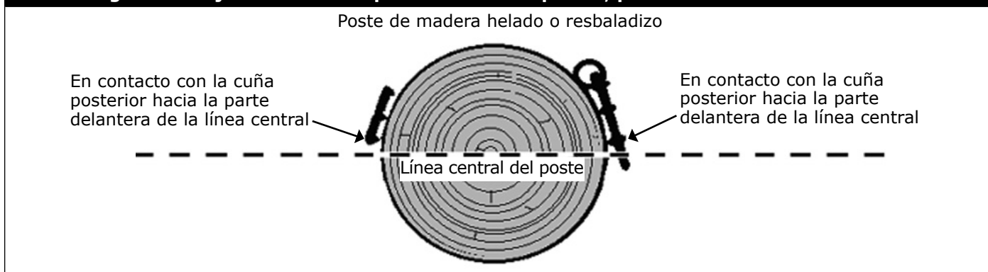
Figura 15 - Ajuste de la cuña para escalado de postes; postes helados o resbaladizos
