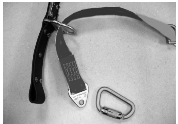
Figura 33 - Desconecte el mosquetón de sujeción del cuerpo de la eslinga de cincha
