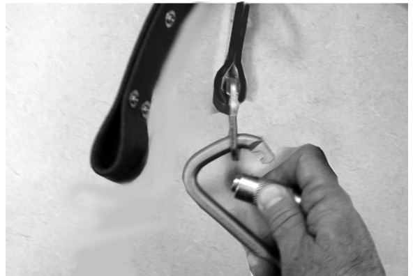
Figura 40 - Conecte el mosquetón de sujeción del cuerpo al extremo de la cincha
