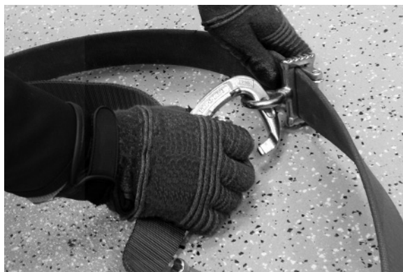
Figura 43 - Modelo de cincha o cuerda, conecte el mosquetón de ojo cautivo al ajustador de rodillos Cynch-Lok
