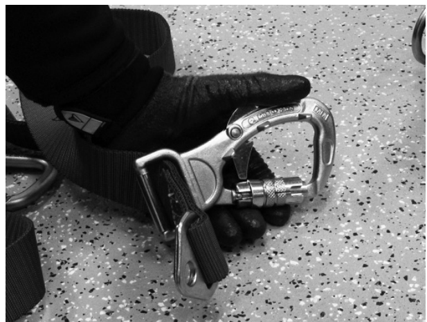
Figura 55 - Inserte la eslinga de cincha en el mosquetón de ojo cautivo (Modelo 1204077)
