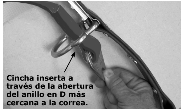
Figura 58 - Inserte la eslinga de cincha a través del anillo en D de doble ranura fija
