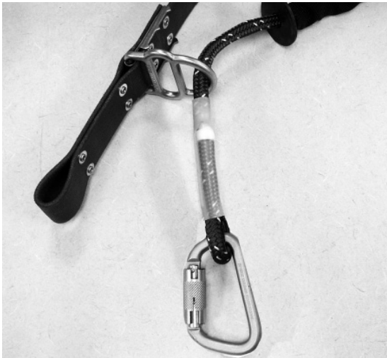
Figura 41 - Mosquetón de sujeción correctamente conectado a la eslinga de cuerda
