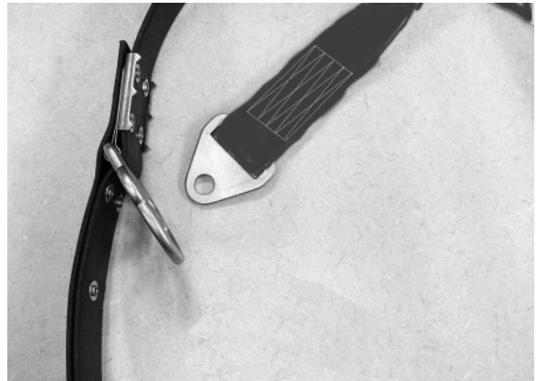
Figura 35 - Tire de la eslinga de cincha a través del anillo en D de doble ranura
