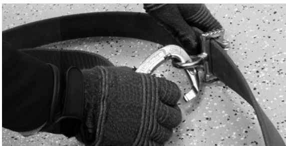
Figura 56 - Modelo de cincha o cuerda, conecte el mosquetón de ojo cautivo al ajustador de rodillos Cynch-Lok
