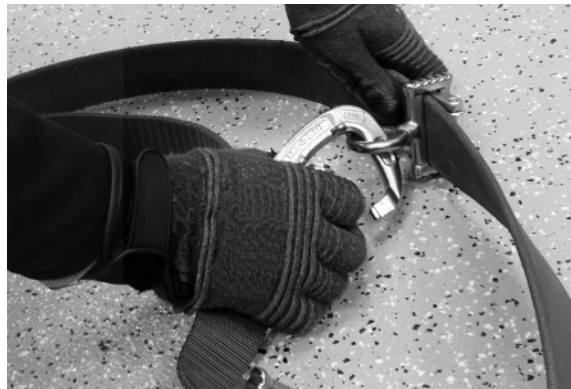
Figura 50 - Eslingas de cuerda o cinchas, desconecte el mosquetón de ojo cautivo del ajustador de rodillos Cynch-Lok
