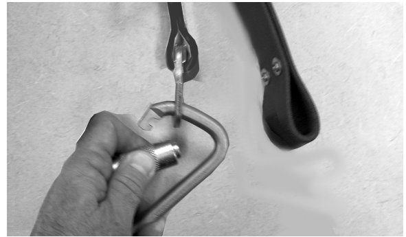
Figura 60 - Conecte el mosquetón de sujeción del cuerpo al extremo de la cincha
