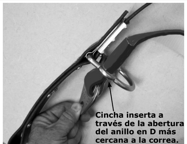
Figura 38 - Inserte la eslinga de cincha a través del anillo en D de doble ranura fija
