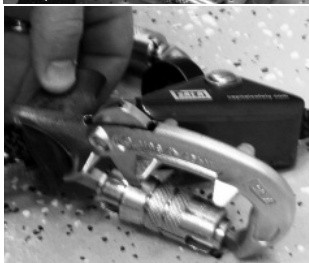
Figura 56 - Modelo de cincha o cuerda, conecte el mosquetón de ojo cautivo al ajustador de rodillos Cynch-Lok
