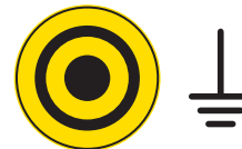
Prise pour mise à la terre
