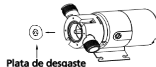
Figura 4 – Remueve placa desgastada
