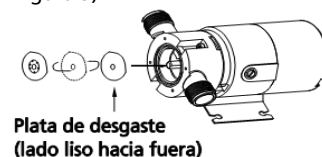
Figure 5 – Instala la placa desgastada
