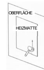
Abbildung B: Aufrollen der Heizmatte
