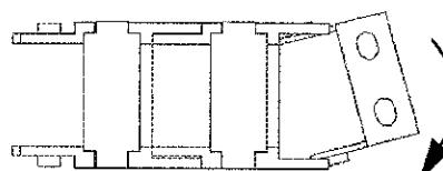
Monter les maillons de fixation sur le CableTrak de sorte que la surface du dessus du maillon soit dans le même plan que la surface extérieure incurvée du CableTrak
