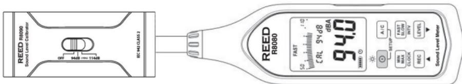
Pour étalonner le R8080, un étalonneur externe pouvant fournir un signal de 94,0 dB est requis (REED R8090). Si le sonomètre a été exposé à des conditions extrêmes ou n'a pas été utilisé depuis longtemps, il doit être étalonné suivant les étapes 1 à 6 ci-dessous.
