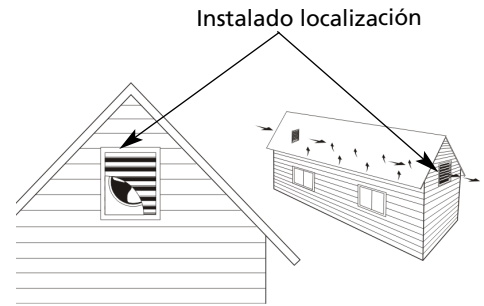
Figure 3 – Localización y apertura de la toma de aire
